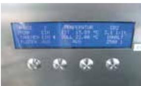
Optional können Sie anstelle der konventionellen Steuerung unsere neue dynamische Maischegärtanksteuerung erwerben. Die Steuerung misst den aktuellen CO<sub>2</sub>-Ausstoß über eine korrosionsbeständige Sonde am Belüftungsstutzen des Tanks. Die Sonde gibt ihre Messwerte laufend an die Steuerung weiter. Dadurch erkennt die Steuerung, wann die Gärung beginnt und je nach Intensität, in welcher Phase sich die Gärung befindet.
