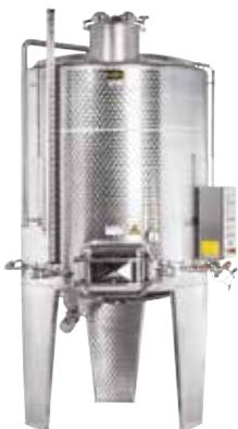
Eine elektronische Steuerung regelt die Intervalle der Injektionen. So können während der Maischegärung in bestimmten Zeitintervallen Injektionen ausgelöst werden, die den Maischekuchen durchmischen. Dabei wird über die Düsen für ca. 15 Sekunden bei einem Luftdruck von 6 bis 8 bar Luft eingespült. Dadurch löst sich das CO<sub>2</sub> aus den Trauben und es kommt zu einer Umschichtung der Maische im Tank.
