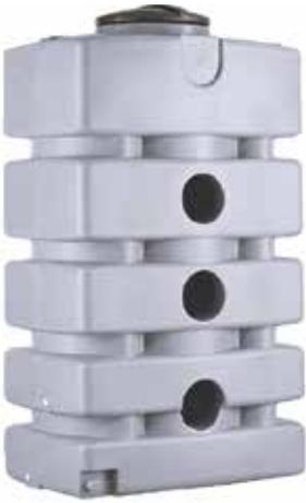
Ob drinnen oder draußen: Flexible Regenwasser-Nutzungsanlagen sind das Spezialgebiet des Kellertanks. Der 1.500-Liter-Tank ist schnell aufgebaut und längs oder quer durch weitere Tanks einfach erweiterbar. Dazu sind an drei Seiten des Tanks Planflächen mit Markierungen für Zulauf, Überlauf und Entnahme angebracht. Eine Tankbatterie aus Kellertanks kann sogar an den Regensammler (siehe Seite 36) angeschlossen werden.
